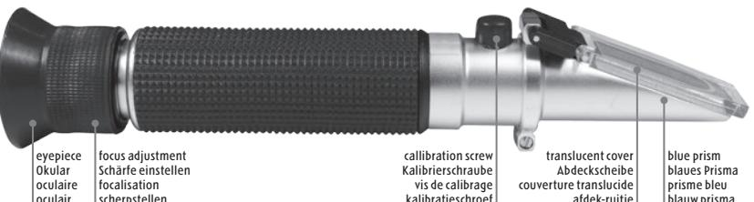
Das Blue Marine Refraktometer wurde speziell für die Messung der Salinität in Meerwasser entwickelt und nicht, wie es fälschlicherweise einige andere Refraktometer tun, nur für die Messung des Natrium Chlorid Levels. Das Refraktometer ist mit einer automatischen Temperaturkompensation ausgestattet, wodurch es bei normaler Raumtemperatur korrekt funktioniert. Die Kalibrierung ist wichtig für korrekte Messungen und sollte regelmäßig durchgeführt werden.
